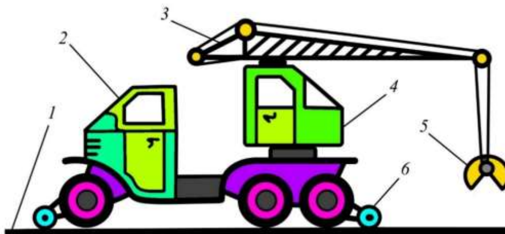
Рис. 1. Локомобиль: 1 — рельс; 2 — кабина водителя; 3 — грузоподъемный кран; 4 — кабина крановщика; 5 — грейфер для металлолома; 6 — направляющий железнодорожный ролик
