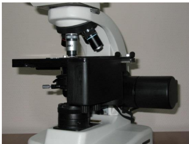
Рис. 2. АКМ «Гранат»: моторизованный предметный стол, выполненный на основе штатного предметного стола микроскопа «Микмед-2» (2007-й год)
