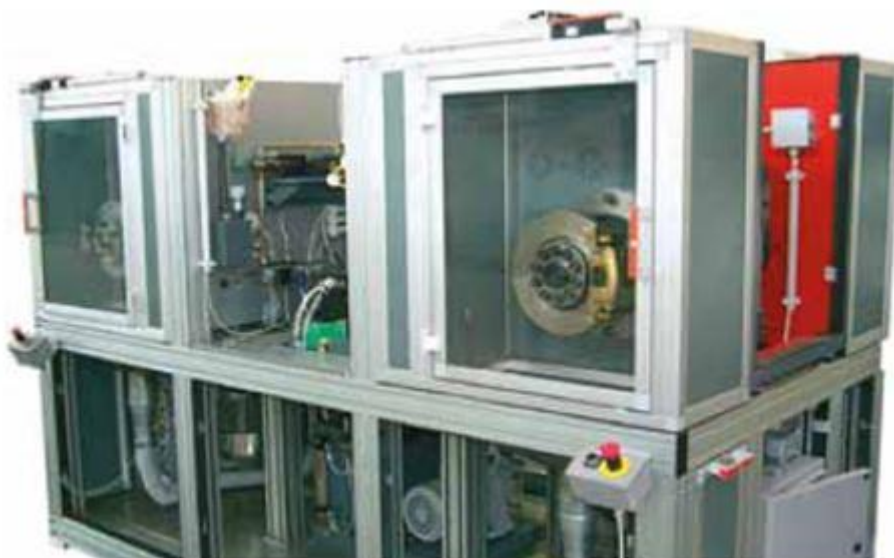
Рис. 3. Стенд для испытаний тормозных механизмов компании Control Sistem [6]
