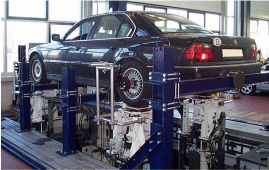
Рис. 1. Стенд для испытания ходовой части легкового автомобиля в инженеринговом центре Аахенского технологического университета (Aachen University of Technology) [4]
