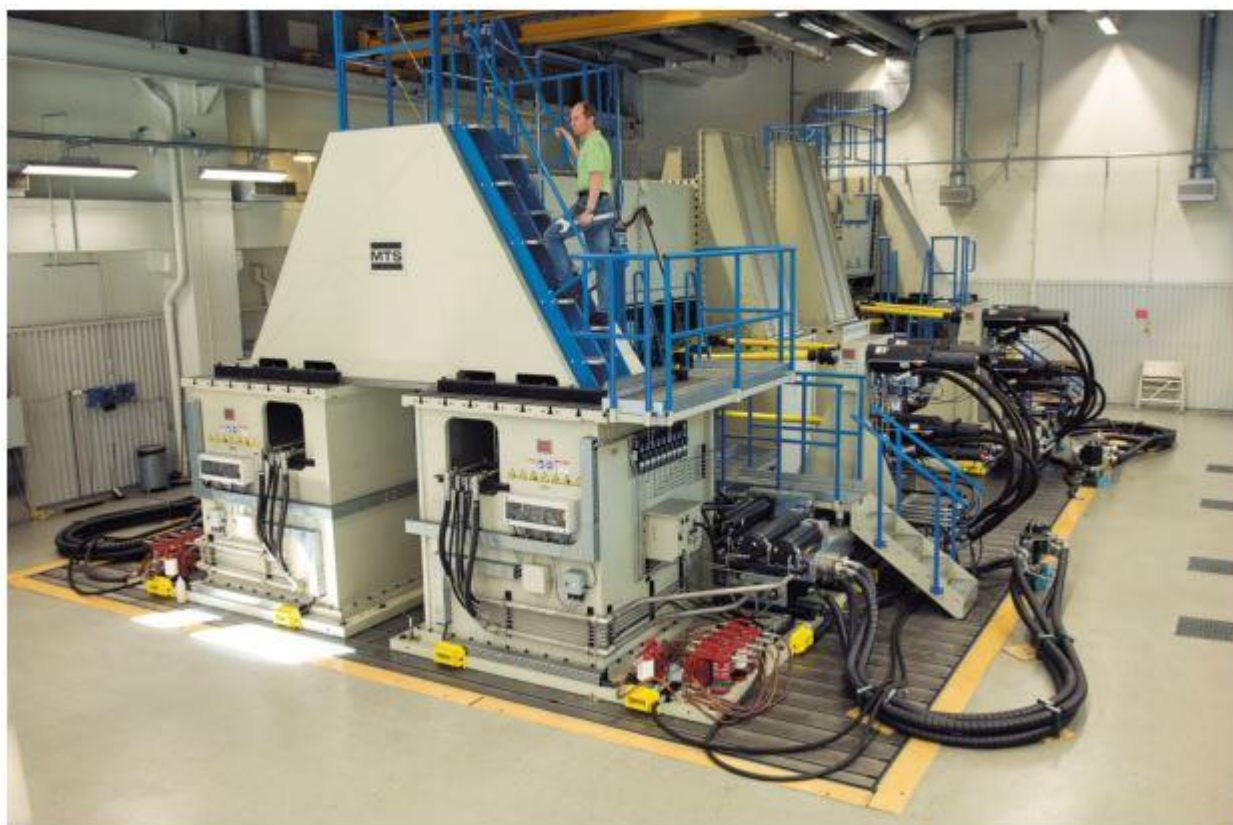
Рис. 6 – Испытательный стенд компании Volvo Truck для оценки систем привода ведущих колес [10]
