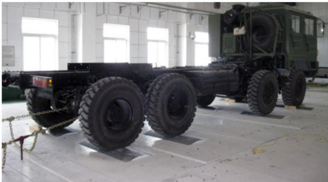
Рис. 11 – Испытание автомобиля 8x8 на динамометрическом барабанном стенде МАЕ [17]
