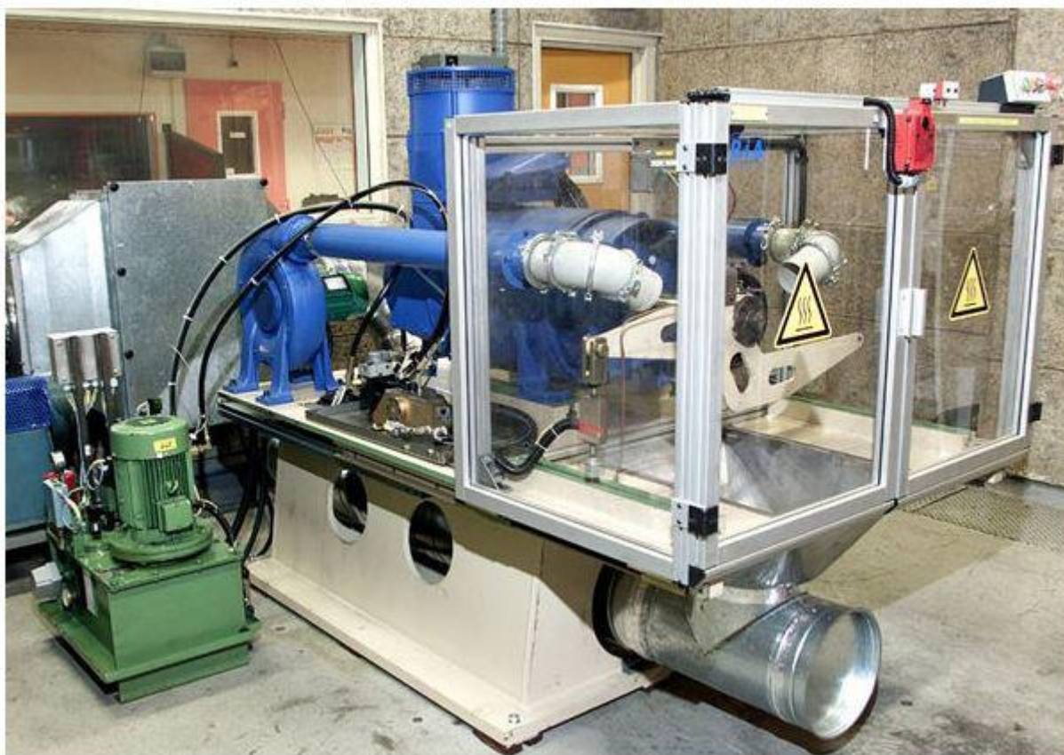
Рис. 7 – Стенд ВИА для испытаний тормозных механизмов на прочность и долговечность [15]
