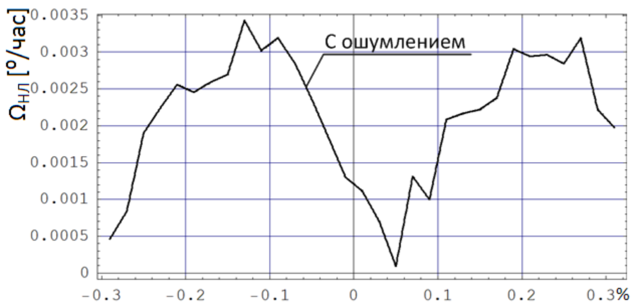
Рисунок 6 - Зависимость систематической составляющей ошибки, обусловленной нелинейностью выходной характеристики, ( \Omega_{нл}(T_{уср}) для \Omega_{изм} = 12.4 °/час) от амплитуды угловых колебаний виброподставки при наличии «ошумления», изменяемой в процентах от выбранной начальной величины, равной 1 угл. минуте.
