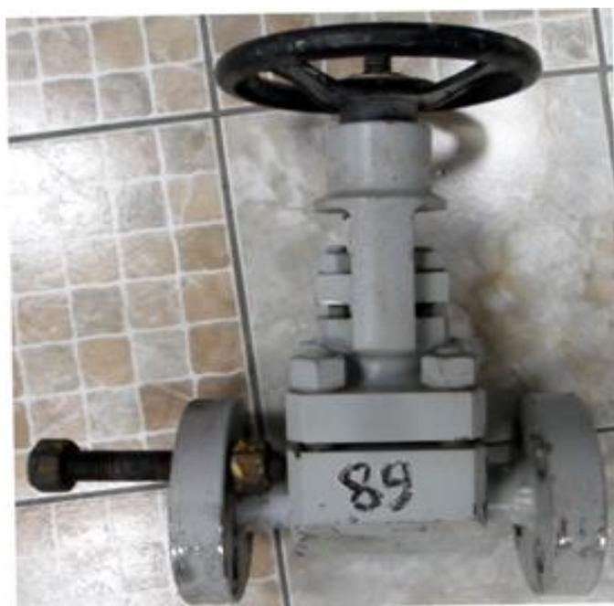
Рис.1. Внешний вид клиновой задвижки 1" Class 2500 по ASME RTJ
