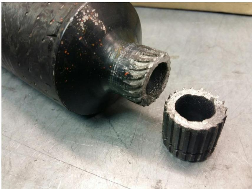
**Рис.10.** Разрушение изделия в области шлицов
