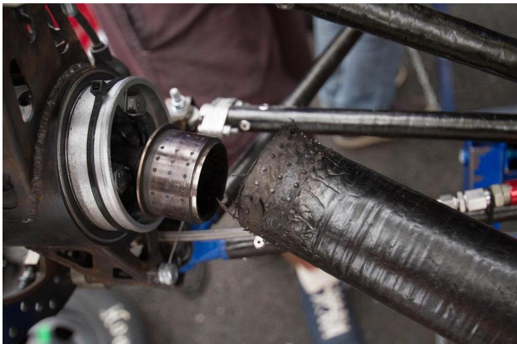
Рис. 12. Разрушенные композитного приводного вала
