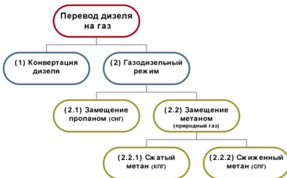
Рис. 2. Способы перевода дизельных двигателей на газовое топливо.
