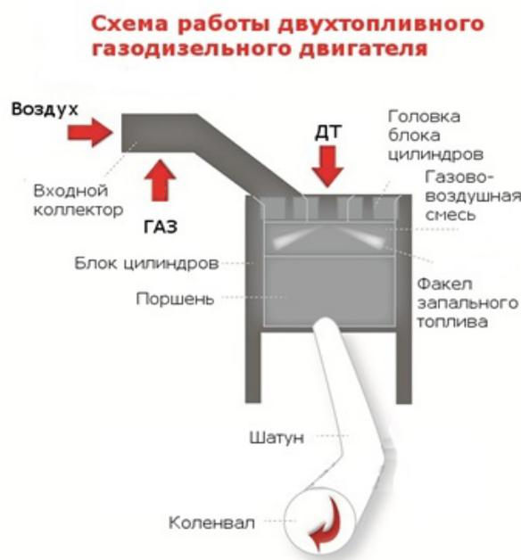
Рис. 3. Схема работы двухтопливного газодизельного двигателя
