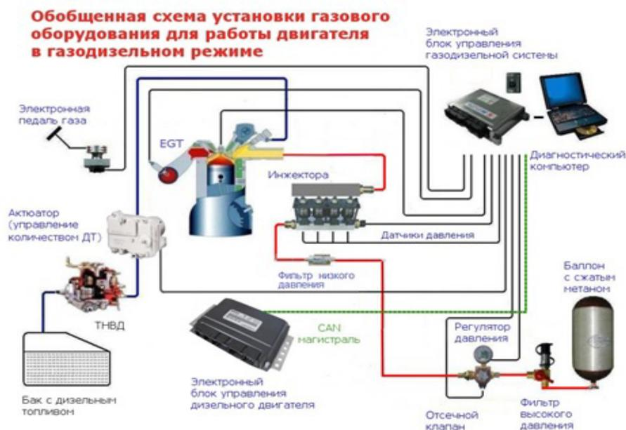
Рис. 5. Обобщенная установки газового оборудования для работы двигателя в газодизельном режиме
