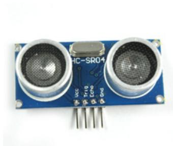
Рис. 2. Ультразвуковой датчик
