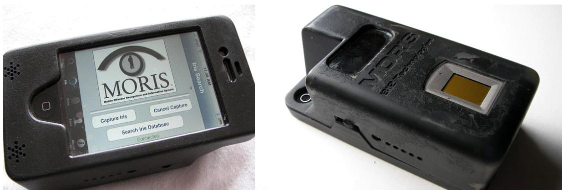
Рис. 2. Система сканирования сетчатки глаза MORIS, управляемая мобильным телефоном
