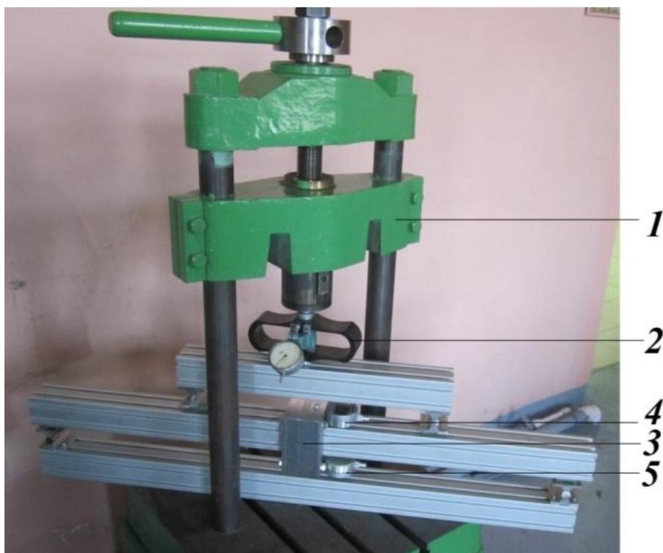
**Рис. 6.** Экспериментальная установка: 1 – пресс; 2 – динамометр; 3 – резьбовое соединение; 4 – индикатор часового типа, измеряющий сближения на стороне, подвергающейся сжатию; 5 – индикатор часового типа, измеряющий удлинения на стороне, подвергающейся отрыву
