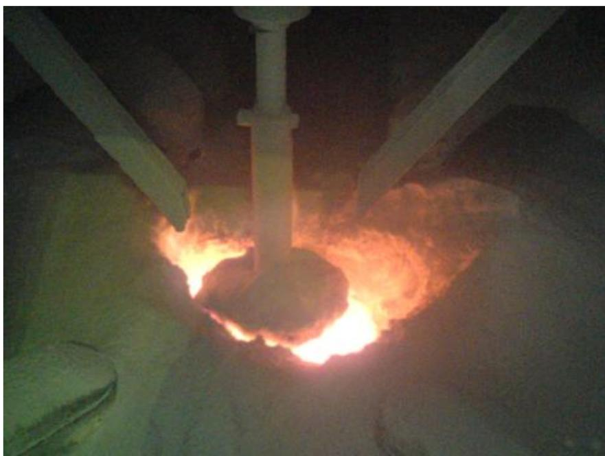
**Рис. 3.** Пробойник при неправильном погружении
