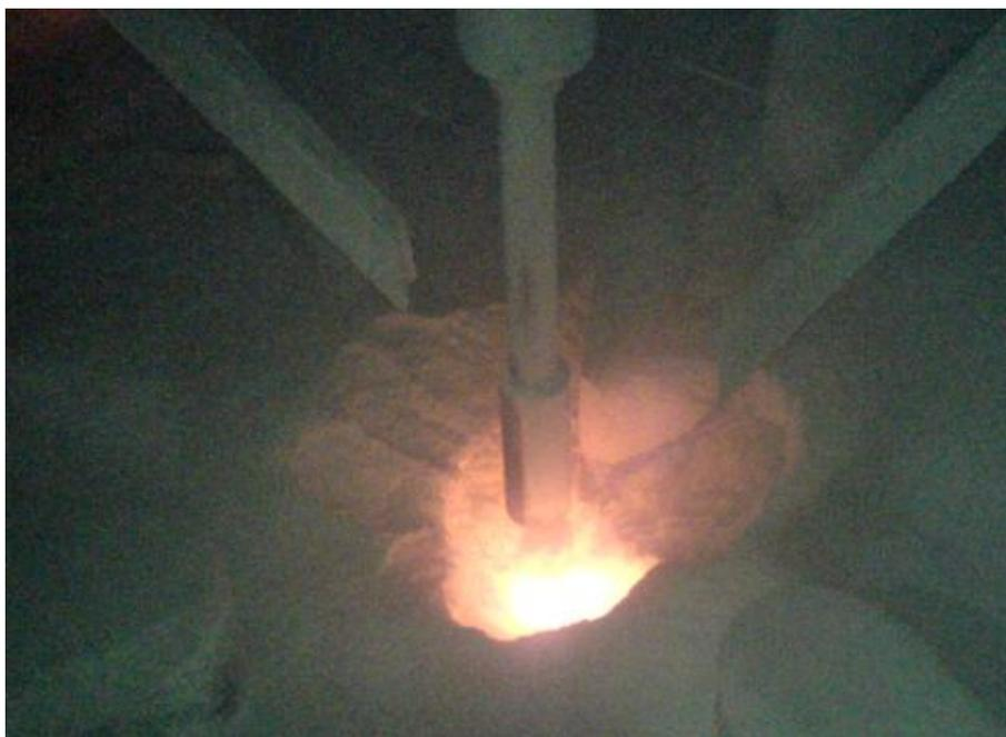
**Рис. 2.** Пробойник
