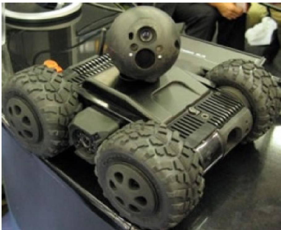
Рис. 2. Малогабаритная роботизированная платформа EyeDrive
