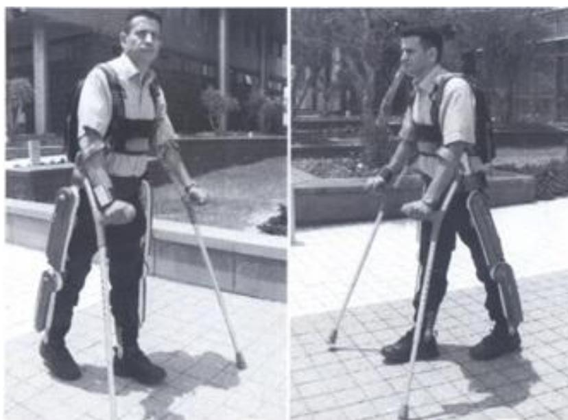
**Рис. 5.** Реабилитационные шагающие механизмы Rewalk
