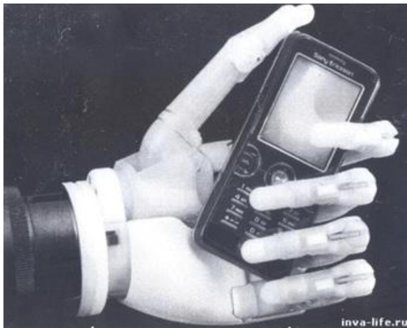
**Рис.1.** Протез кисти руки фирмы «Touch Bionics»
