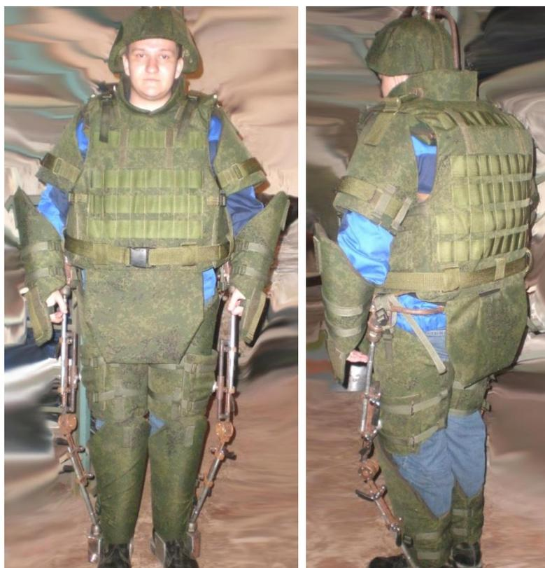
**Рис. 2.** Натурный экспериментально-опытный образец системы СИБ и БТЭ
