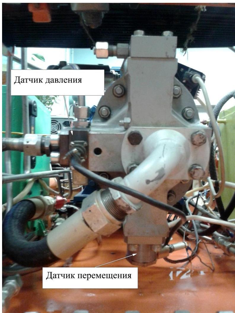
Рис. 5. Вид комплекта измерительной аппаратуры
