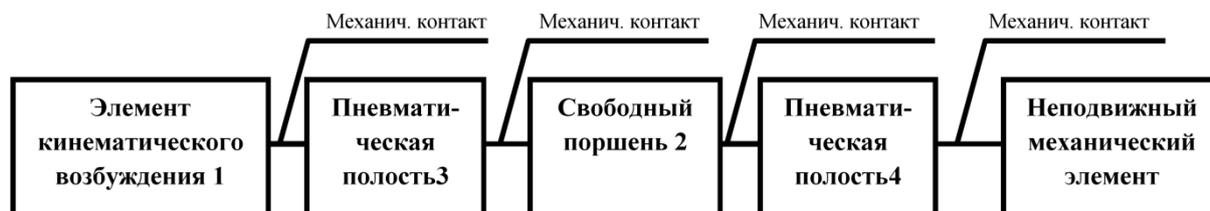
Рис. 2. Функциональная блок-схема амортизатора
