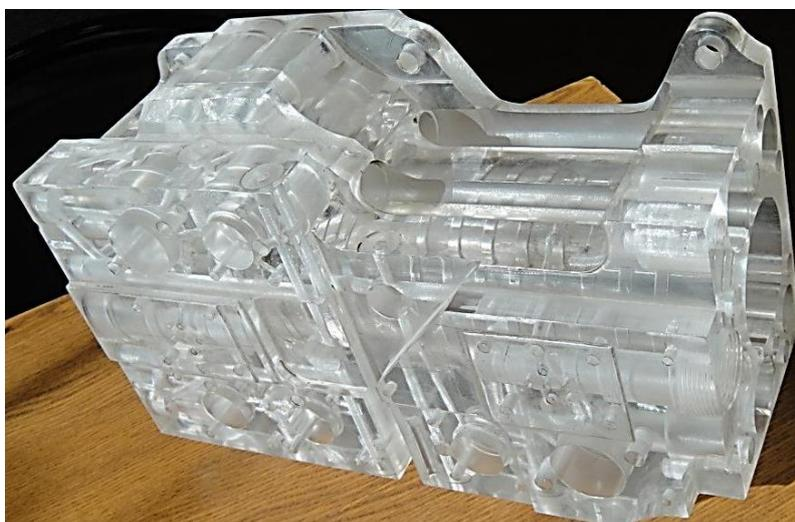
**Рис.6.** Пример макета прозрачного пластикового корпуса золотникового устройства гидропривода с выполненными внутренними каналами (канализацией).
