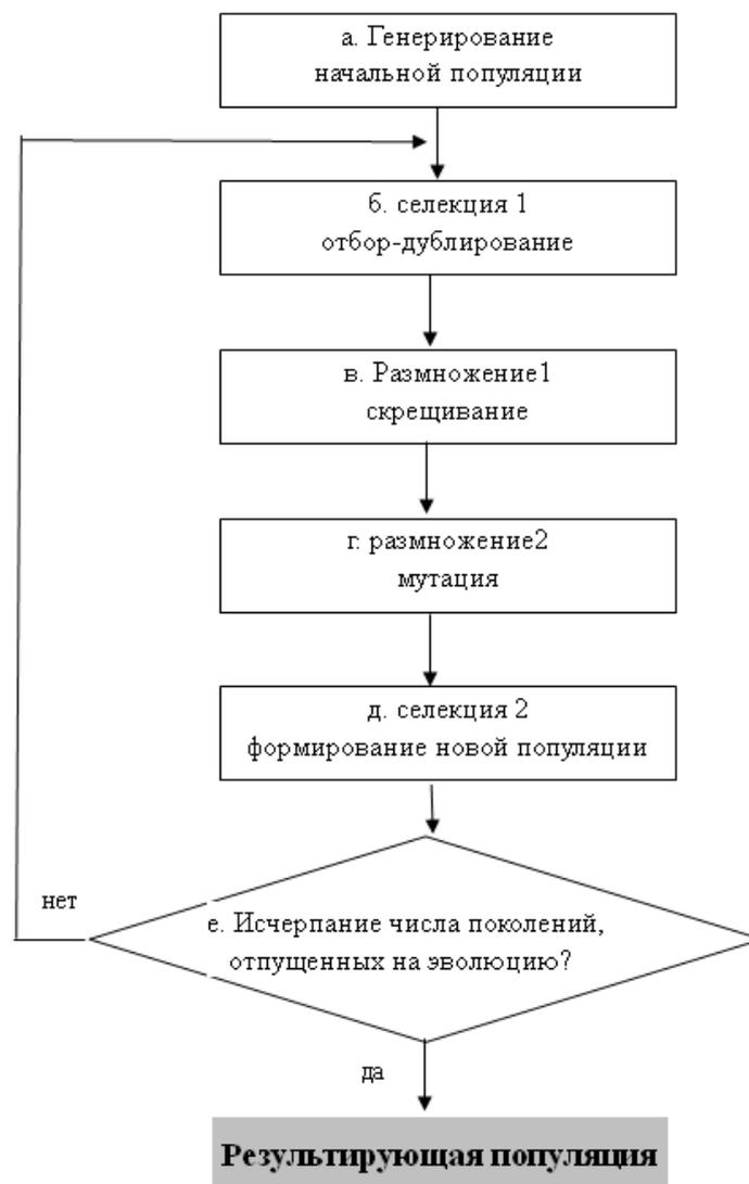
Рис. 1. Структурная схема классического генетического алгоритма
