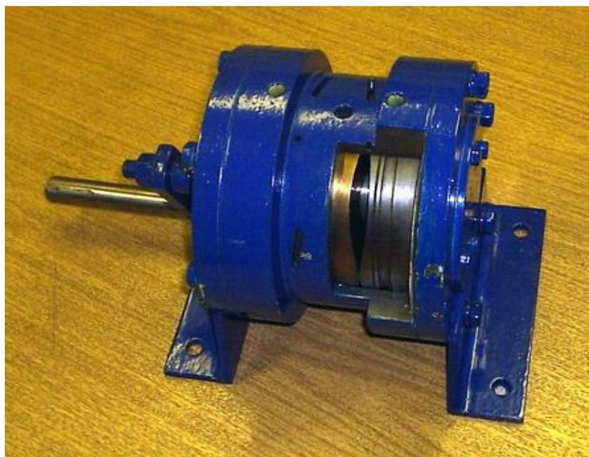
Рис. 1. Макет роторно-волнового компрессора (показан этап всасывания)
