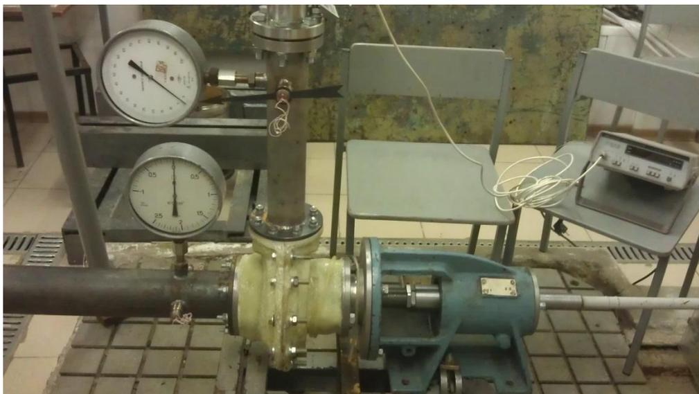
**Рис. 7.** Макет насоса, установленный на стенд
