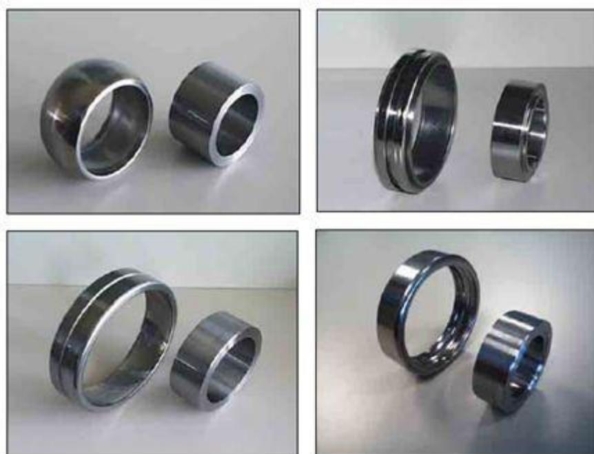
**Рис. 7.** Образцы заготовок и готовых колец, фирма Profiroll [5]
