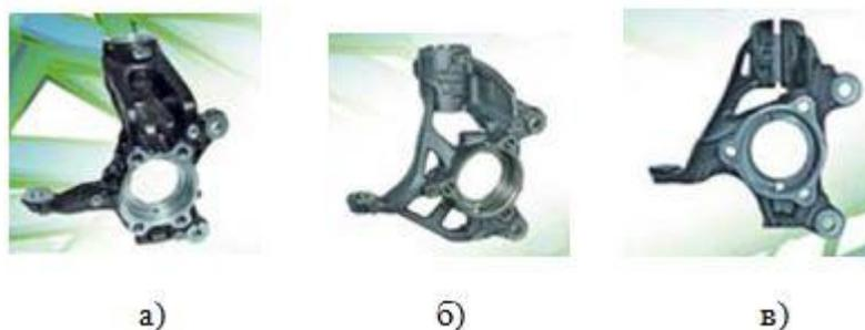
**Рис. 9.** Оптимизация формы поворотного кулака: а – первоначальная форма поворотного кулака, материал – чугун с шаровидным графитом (GJS) 400-15, вес 4,39 кг; б – вариант 1 оптимизации, материал – Sibo (GF) 700-10, вес 3,42 кг; в – вариант 2 оптимизации, материал - Sibo (GF) 700-10, вес 2,98 кг
