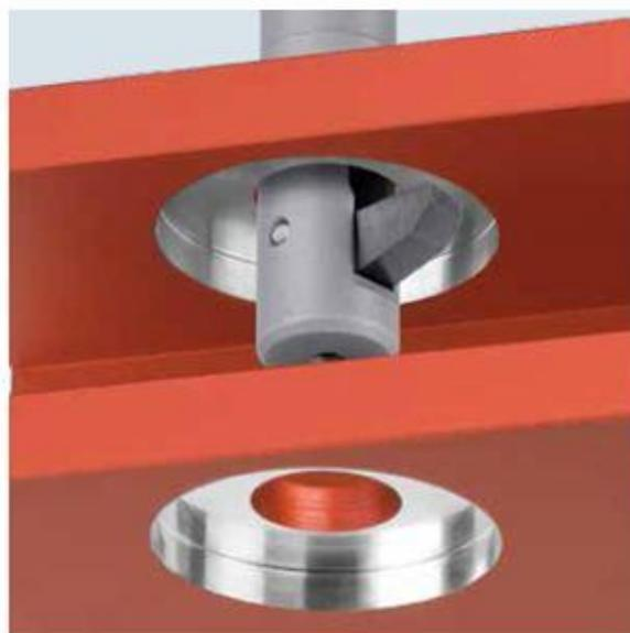
Рис. 2. Технология зенкерования компании Heule
