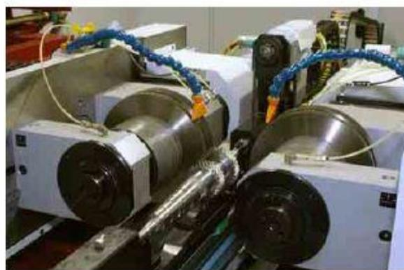
**Рис. 6.** Накатка профилей, фирма Profiroll [5] а – валы коробок передач; б - полуоси
