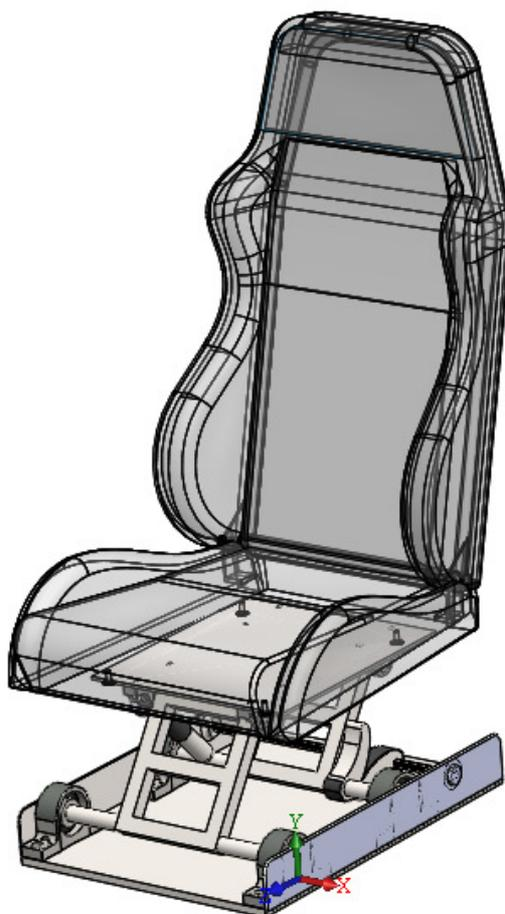
Рис. 1. Кресло водителя с нелинейным поддресориванием
