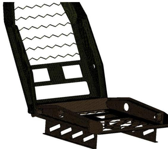
Рис. 10. Моделирование каркаса кресла
