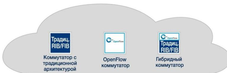
Рисунок 6 – Категории сетевых устройств.
