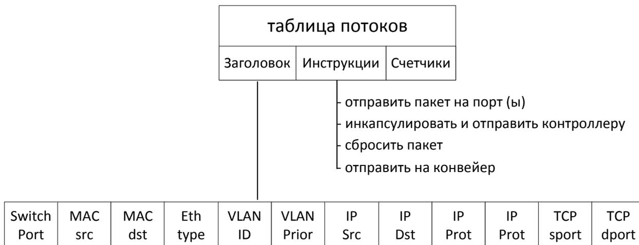
Рисунок 3 – Таблица потоков в OpenFlow – коммутаторе
