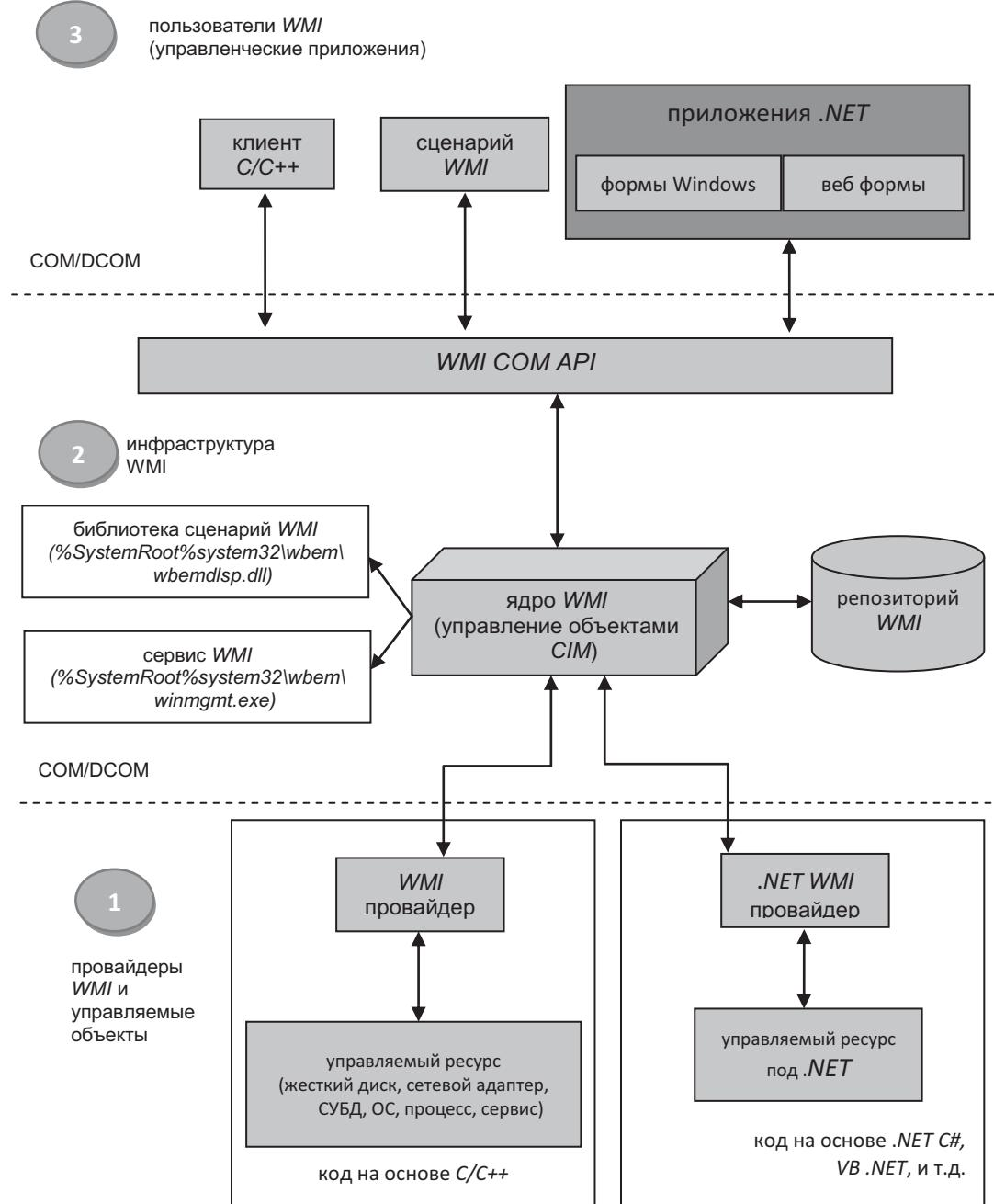
Рис. 4. Архитектура WMI (*Windows Management Instrumentation*)
