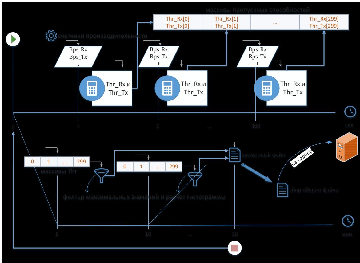
Рис. 5. Процесс сбора данных для вычисления пропускной способности конечного Интернет – пользователя
