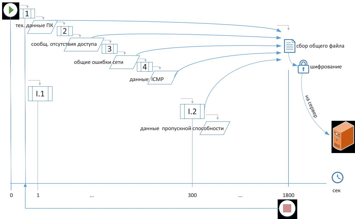
Рис. 6. Завершенный процесс сбора данных перед передачей на сервер
