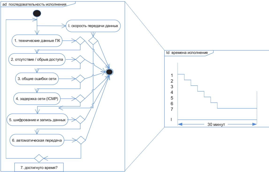
Рис. 3. Диаграммы действий и диаграмма времени (UML) для программного обеспечения на ПК пользователя
