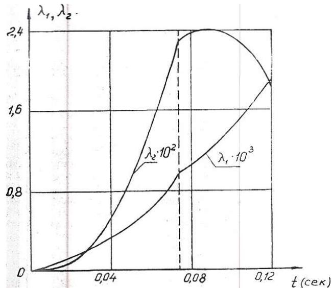
Рис. 2. Зависимость функций чувствительности фазовых координат системы от времени
