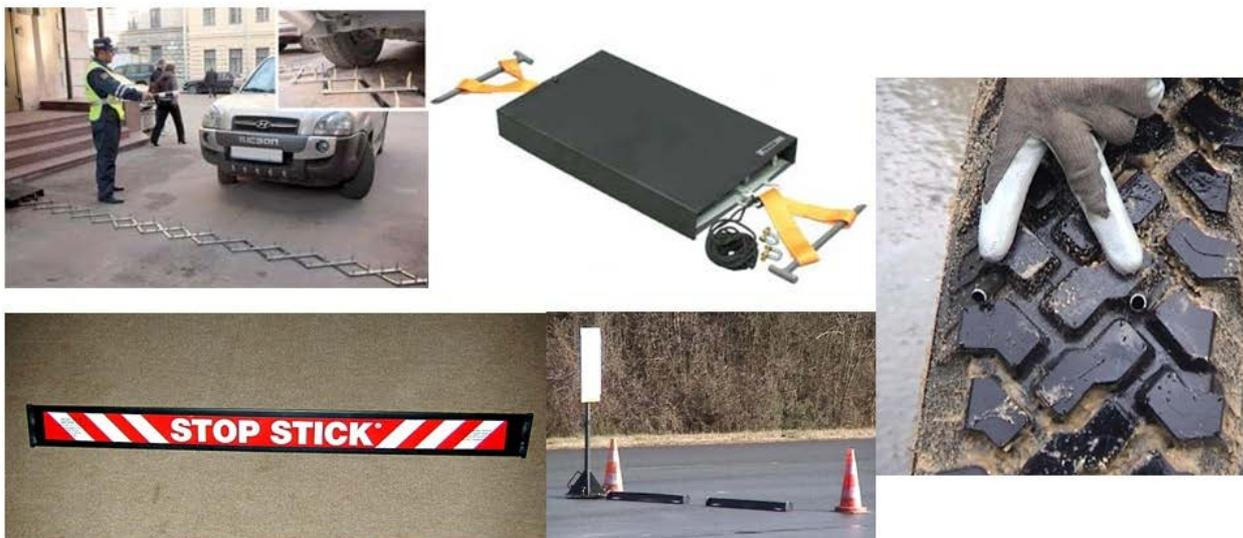
Рис. 7. Устройства остановки транспортных средств первого поколения:
