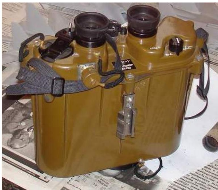
**Рис. 2. Ручной лазерный дальномер ЛПР-1**
