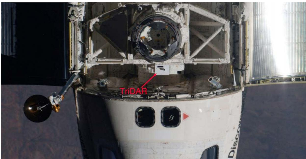
**Рис. 14. TriDAR на борту КА «Space Shuttle»**
