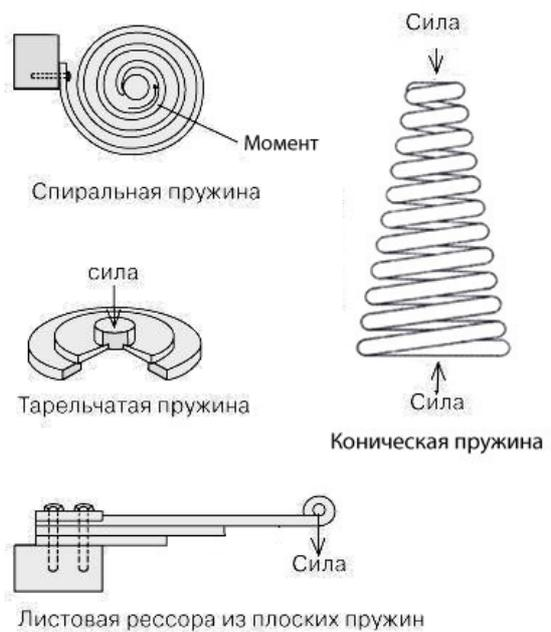
Рис. 2. Виды пружин
