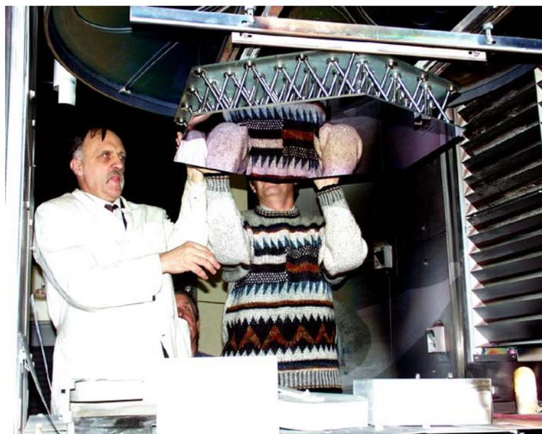
Рис. 9. Снятие готового зеркала после вакуумного напыления отражающего покрытия.
