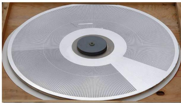
Дисковый носитель записи для AMPEX HS-100
