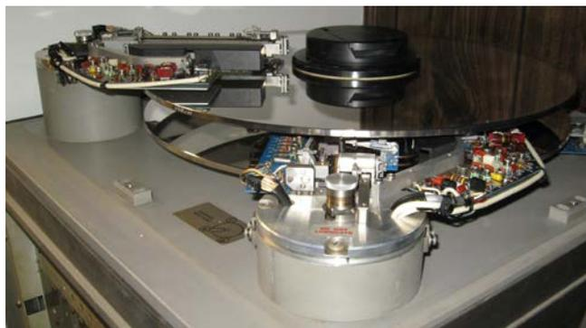
Аппарат AMPEX HS-100 для видеозаписи на диск
