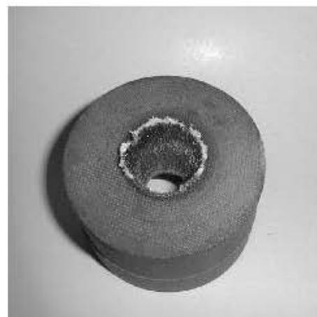
Рис. 2.27. Вкладыш критического сечения после огневого стендового испытания
