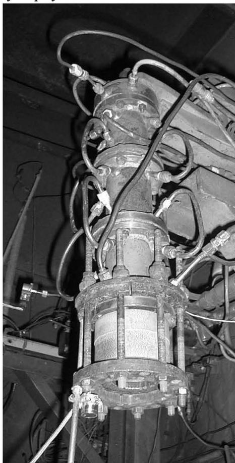
Рис. 1. Общий вид камеры сгорания модельного ЖРД
