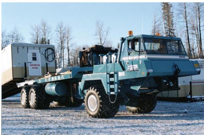
Рис.6. Транспортер «Foremost Commander C» типа 6x6
