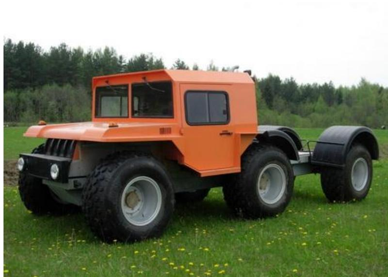
Рис. 5. Вездеходное транспортное средство 6х6 со стеклопластиковой четверть-эллиптической рессорой
